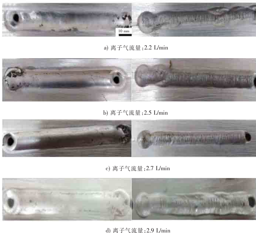
图 6 离子气流量对焊缝外观形貌的影响
