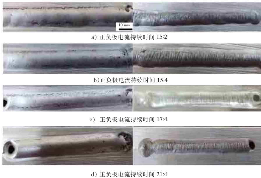
图8 正负极电流持续时间对缝外观形貌的影响
