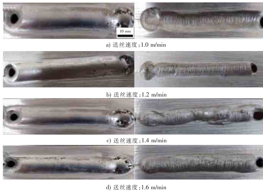
图 10 送丝速度对焊缝外观形貌的影响
