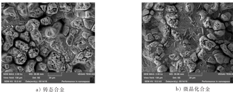
图 4 Fe-5Cr 合金 900 °C 氧化 100 h 后的表面 SEM 形貌
