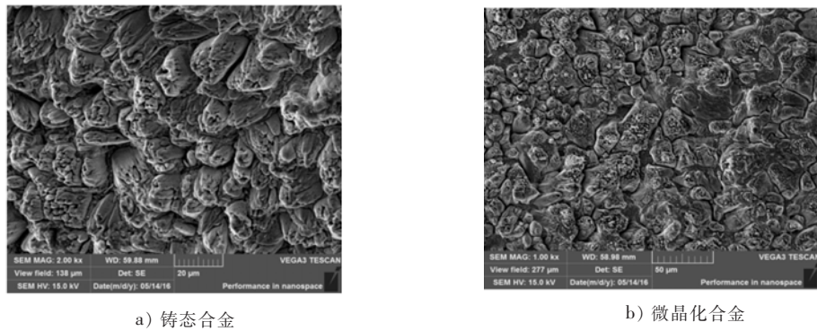
图 6 Fe-13Cr 合金 900 °C 氧化 100 h 后的表面 SEM 形貌
