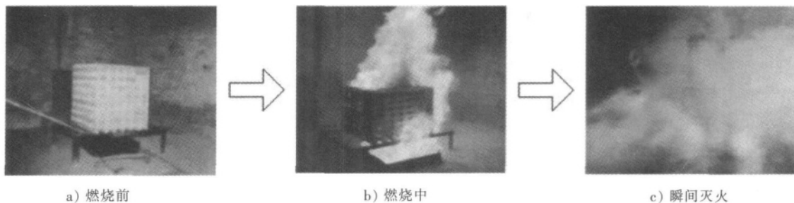
图8 灭A类火灾试验
