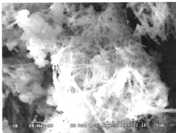
图5 二氧化硅纳米管的 SEM 图(267.5 mL 氨水)
