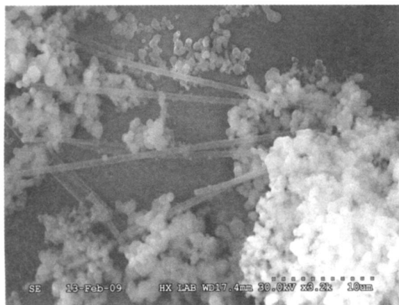
图3 二氧化硅纳米管的 SEM 图(快速滴加)
