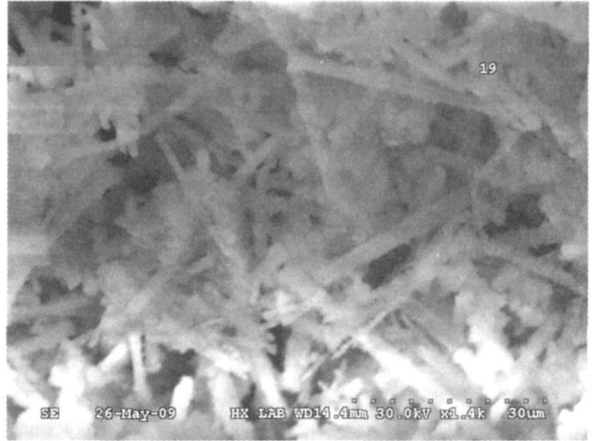
图 8 二氧化硅纳米管的 SEM 图(反应温度:25~28 °C)
