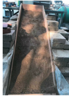
图 2 边坡物理试验模型
