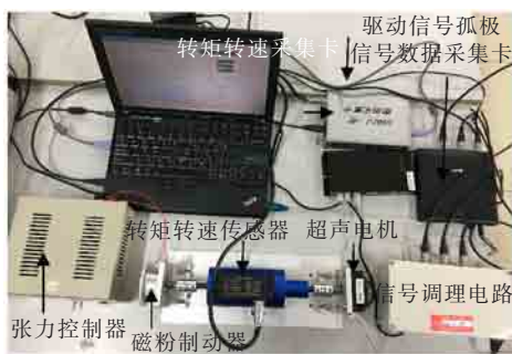
图 8 超声电机实验平台
