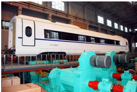
图1 动车组蛇行失稳滚振试验
